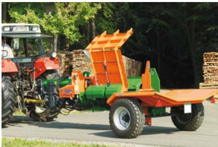
Der SplitMaster 30 mit längsgezogenem Schlepperfahrwerk für den mobilen Einsatz.
