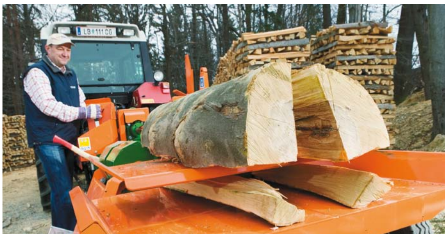
SplitMaster 20 optional mit „Easy“-Spaltmesser und längsgezogenem Schlepperfahrwerk.
