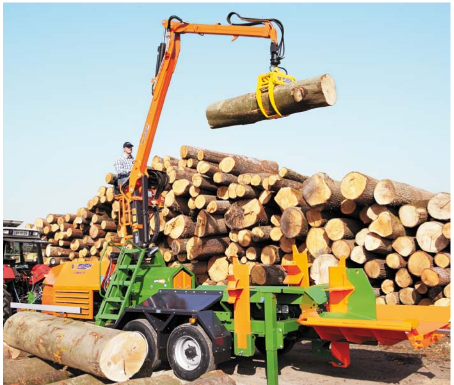
SplitMaster 55 Crane. Der Ladekran hebt Stämme bis zu einem Gewicht von 1.200 kg in die Spaltmulde.
