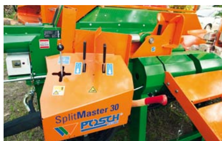
Zweihand-Bedienung. Joystick für Hebevorrichtung und Messerverstellung.
