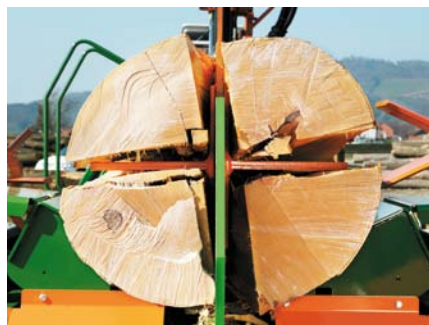
Das hydraulisch verstellbare Spaltmesser zum kraftvollen Spalten des Spaltgutes.
